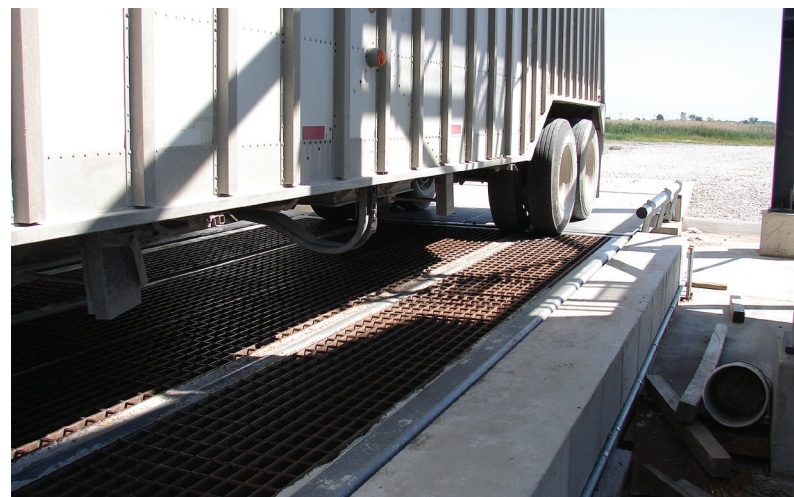
Los procesos se han optimizado mediante la integración de descargadores de grano directamente en la plataforma de pesaje.
